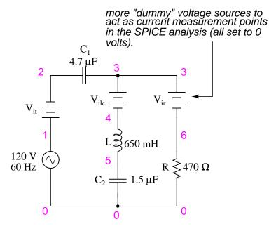
ac series-parallel r-l-c circuit v1 1 0 ac 120 sin vit 1 2 ac 0 vilc 3 4 ac 0 vir 3 6 ac 0 c1 2 3 4.7u l 4 5 650m c2 5 0 1.5u r 6 0 470 .ac lin 1 60 60 .print ac v(2,3) vp(2,3) i(vit) ip(vit) .print ac v(4,5) vp(4,5) i(vilc) ip(vilc) .print ac v(5,0) vp(5,0) i(vilc) ip(vilc)
