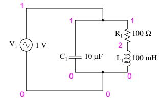
resonant circuit v1 1 0 ac 1 sin c1 1 0 10u r1 1 2 100 l1 2 0 100m .ac lin 20 100 200 .plot ac i(v1) .end
