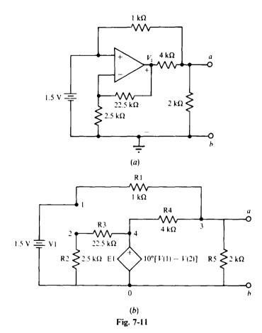
CIRCUIT FILE FOR FIG. 7-11b V1 1 0 1.5 R1 1 3 1K 2.5K R2 2 0 R3 2 4 22.5K E1 4 0 1 2 1MEG R4 4 3 4 K R5 3 0 2 K
