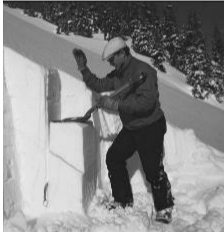
Фиг. 8: Компресивен тест. На снимката ясно се вижда слабият слой върху който се хлъзва лежащият отгоре снежен стълб
