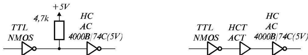
Фиг. 2.46. Свързване от TTL/NMOS към CMOS.
