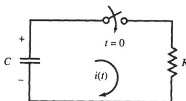
**Fig. 3-20**  $RC$  circuit.
