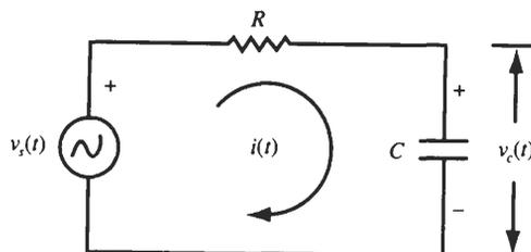
**Fig. 1-32**  $RC$  circuit.
