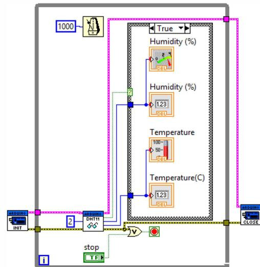
Fig. 3: DHT11 VI Block Diagram
