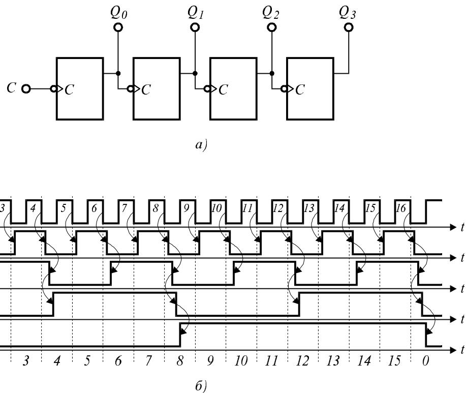
Фиг. 4.19. Четириразреден асинхронен брояч с непосредствена връзка.
