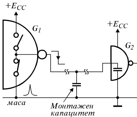
Фиг. 9.3. Генериране на смущаващ паразитен импулс при заряд на капацитет в изхода на логически елемент.
