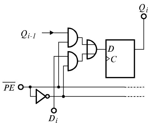
Фиг. 4.55. Синхронно зареждане на  $D$ -тригър.
