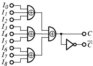
Фиг. 3.35. 9-разреден генератор на контролен бит — '280
