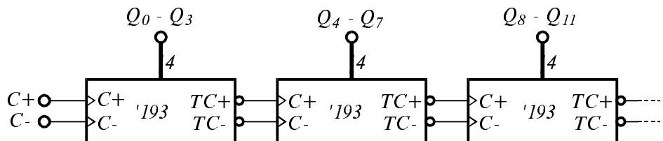
Фиг. 4.35. Асинхронно свързване между реверсивни боячи '193.
