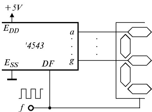
Фиг. 6.10. Управление на течнокристален индикатор с ИС '4543.
