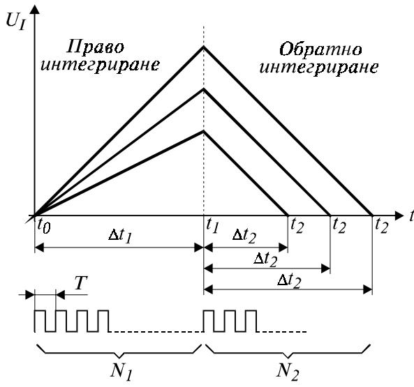
Фиг. 7.29. Времедиаграми на процеса на преобразуване при двутактно интегриращ преbroителен АЦП.
