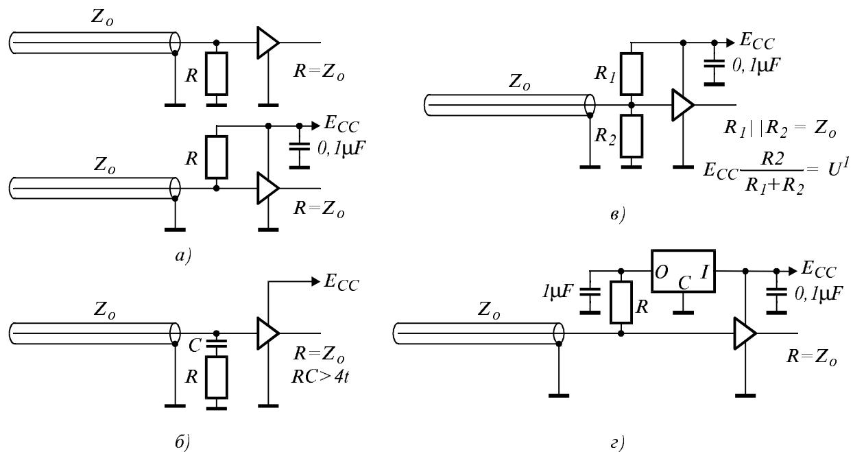
Фиг. 9.9. Терминиране на несиметрични линии с разпределени параметри.
