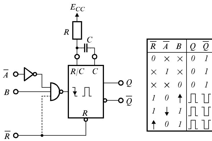
Фиг. 5.9. Функционална схема на интегрален чакащ мултивибратор, с възможност за удължаване на генерирания импулс — 1/2 '123.
