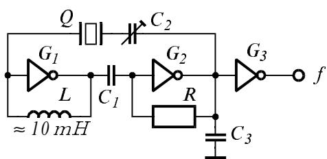
Фиг. 5.27. Кварцово стабилизиран релаксатор за работа на честоти под 1 MHz.
