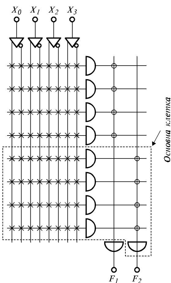
Фиг. 3.40. Структурна схема на PAL.
