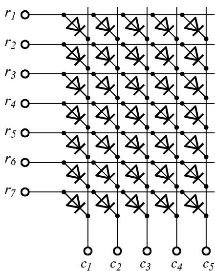
Фиг. 6.18. Структура на светодиоден точково-матричен индикатор  $5 \times 7$ .
