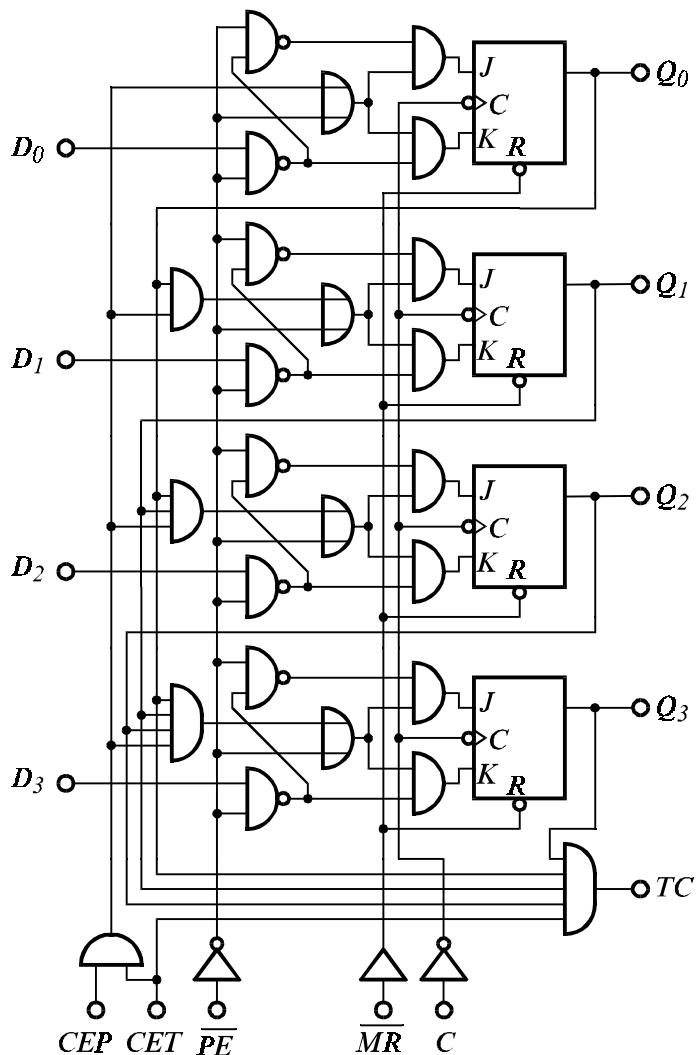
Фиг. 4.40. Схема на четириразреден синхронен брояч '161.
