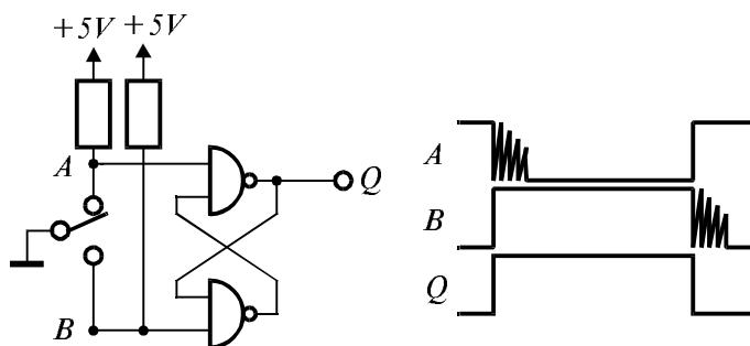
Фиг. 4.4. Отстраняване на смущения от вибрации на механичен контакт.
