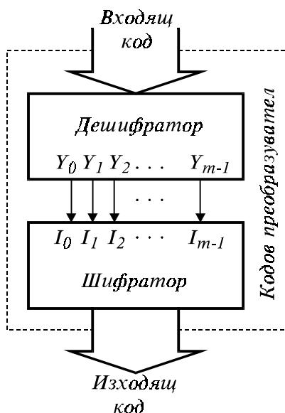
Фиг. 3.19. Кодов преобразувател, реализиран чрез дешифратор и шифратор.
