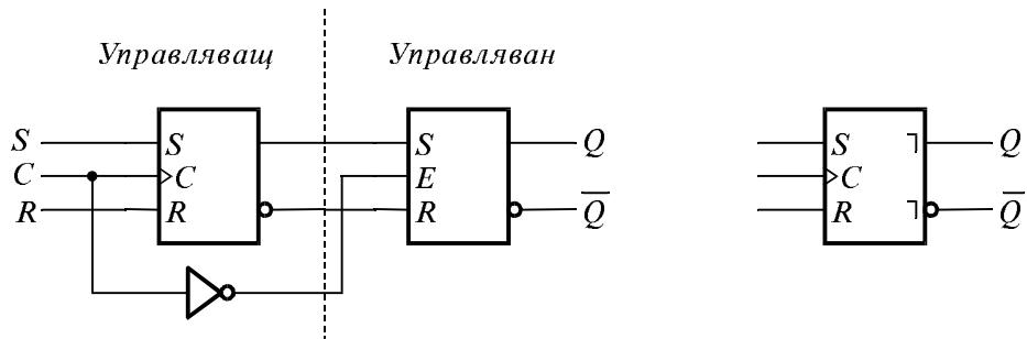
Фиг. 4.10. Двустъпален *SR*-тригер със заключен вход.
