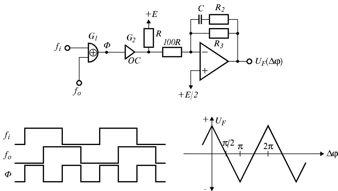
Фиг. 8.3. Цифров линеен фазов детектор от тип 1.
