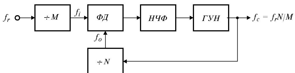
Фиг. 8.10. Обобщена блокова схема на честотен синтезатор.
