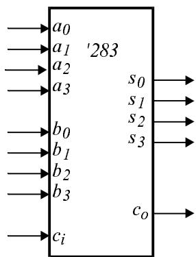
Фиг. 3.32. 4-разреден пълен суматор с ускорен пренос.
