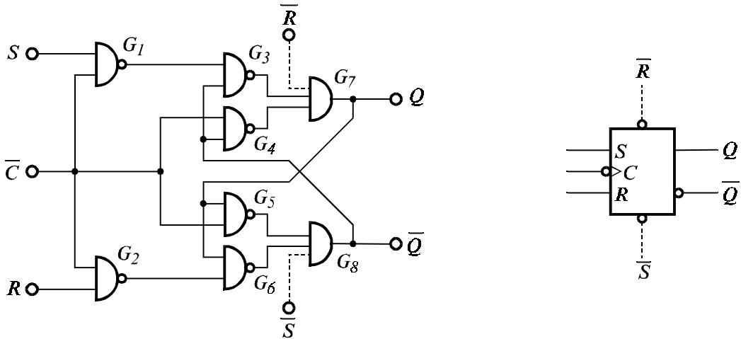
Фиг. 4.7. Синхронен динамичен *SR*-тригер.
