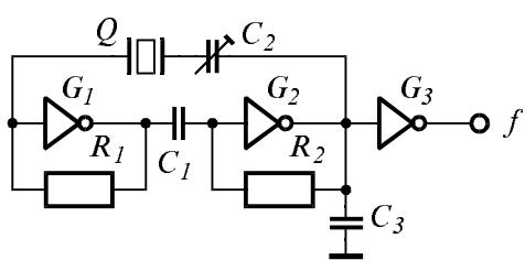
Фиг. 5.26. Кварцово стабилизиран релаксатор, използващ последователния резонанс на резонатора.
