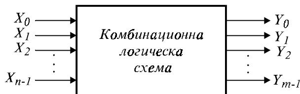
Фиг. 3.1. Общ вид на комбинационна логическа схема
