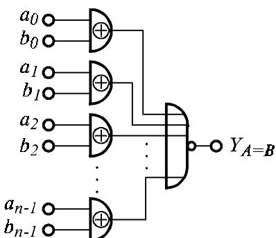
Фиг. 3.24. Сравняване на две  $n$ -разредни числа
