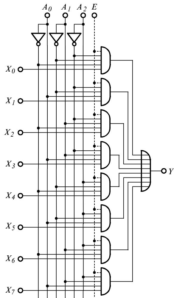
Фиг. 3.13. 8-канален пълен мултиплексор.
