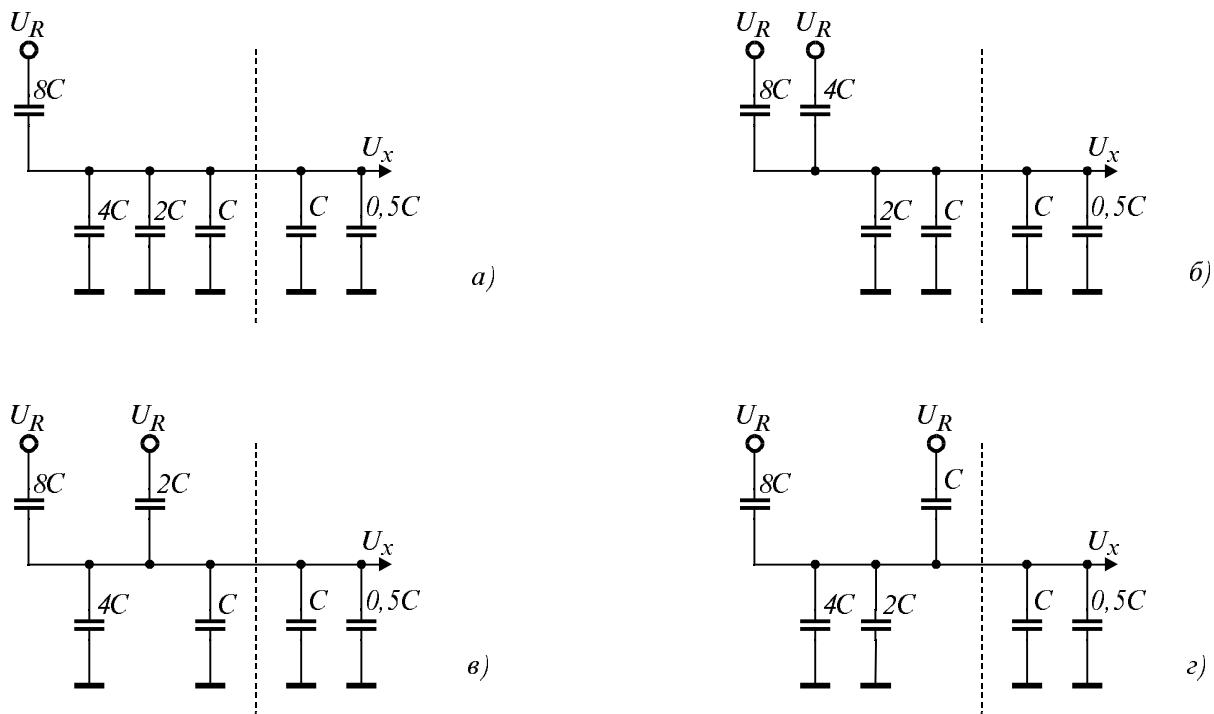
Фиг. 7.26. Последователно пресвързване на капацитивната матрица на 4-разреден АЦП при преобразуване на входно напрежение със стойност  $U_i = 9U_{LSB}$ .
