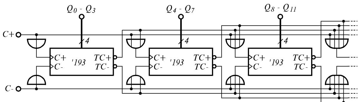
Фиг. 4.38. Паралелно-последователно свързване на синхронни реверсивни броячи '193.
