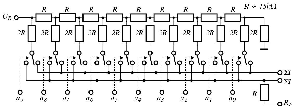
Фиг. 7.12. Вътрешна структура на 10-разредния ЦАП DAC7520.
