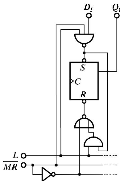
Фиг. 4.30. Съчетание на асинхронно зареждане и приоритетно асинхронно нулиране на боячен тригер.
