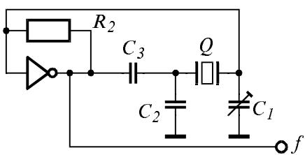
Фиг. 5.30. Генератор на Пирс за работа на честоти над  $4 \text{ MHz}$ .
