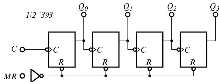
Фиг. 4.34. Структура на асинхронния брояч 1/2 '393.
