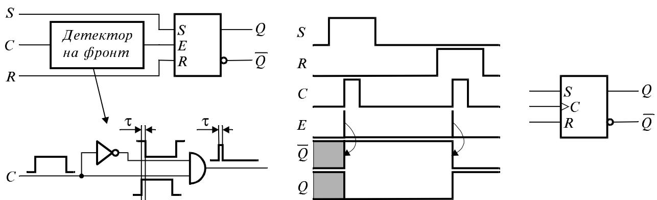
Фиг. 4.6. Опростен  $SR$ -тригър, управляван по фронт на синхронизиращия импулс.
