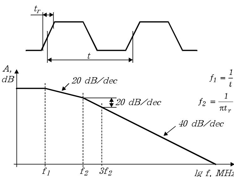
Честотният спектър на периодична импулсна поредица с коефициент на запълване 0,5 (вж. фиг. 1.8) зависи на първо място от основната честота  $f_1$ , определена от периода на повторение  $t$ .  $f_1 = 1/t$ . След тази честота, амплитудата на висшите хармоники намалява с  $20 \text{ dB/dec}$  до честотата  $f_2$ , която се определя от продължителността на фронта на сигнала  $t_r$ ;  $f_2 = 1/\pi t_r$ .
