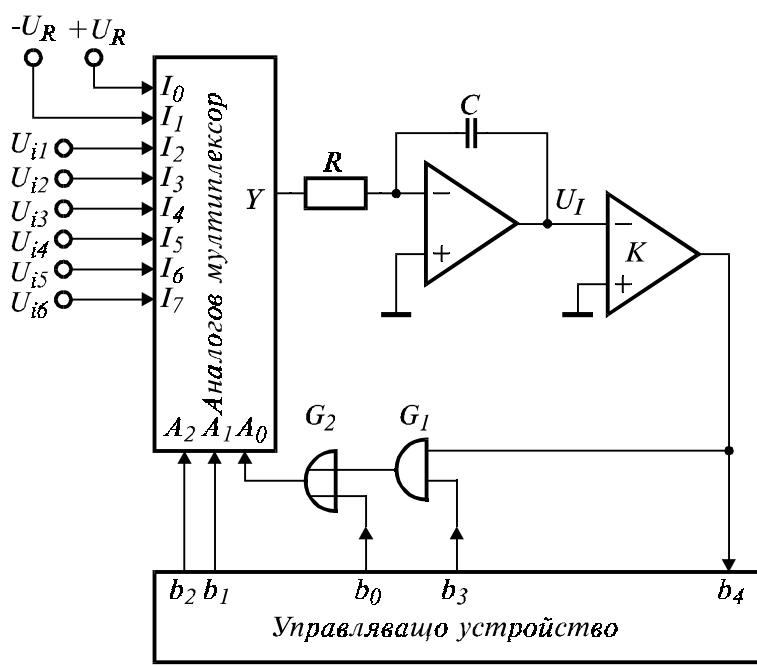
Фиг. 7.30. 6-канален аналогово-цифров преобразувател, работещ по метода на двутактното интегриране.
