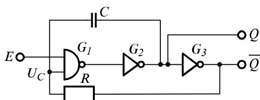
Фиг. 5.21.  $RC$ -релаксатор с използване на двата взаимоинверсни изхода.
