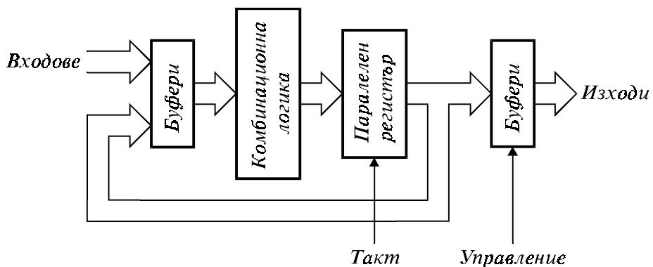
Фиг. 4.60. Обобщена структура на синхронна последователна логика.
