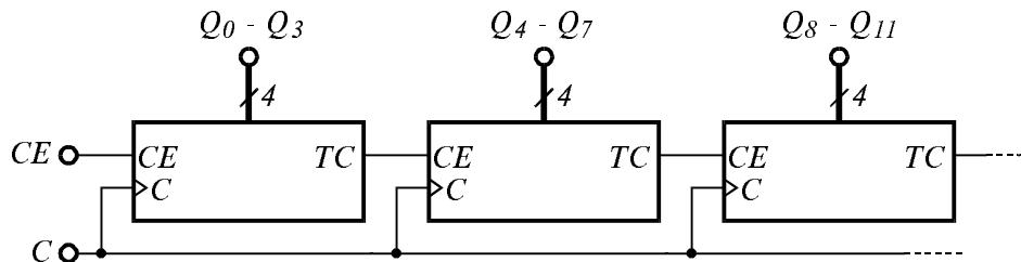
Фиг. 4.37. Синхронно последователно свързване на броячи.
