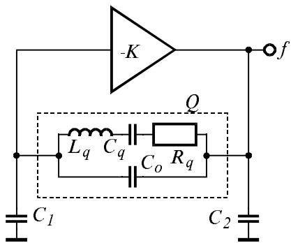
Фиг. 5.28. Структурна схема на генератор на Пирс.
