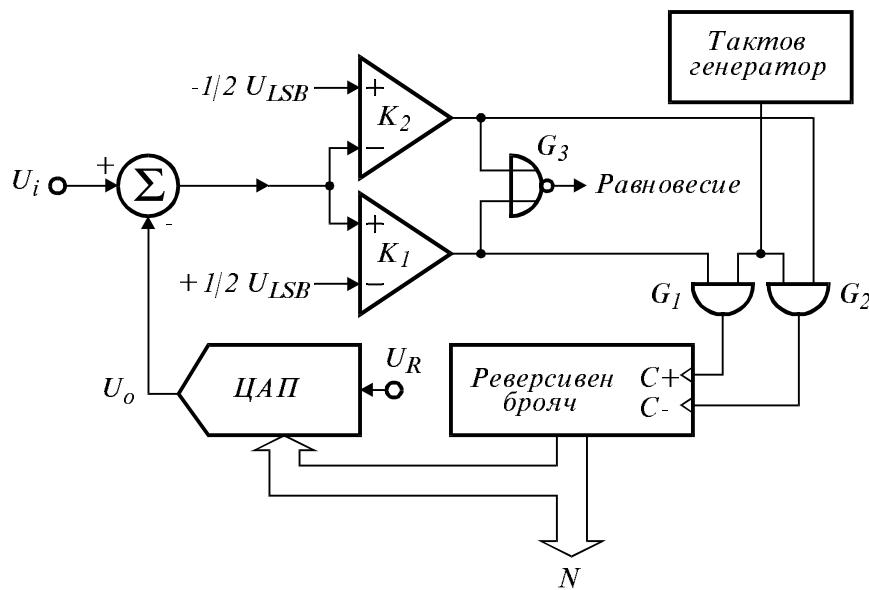
Фиг. 7.27. Преброителен АЦП от компенсационен тип.
