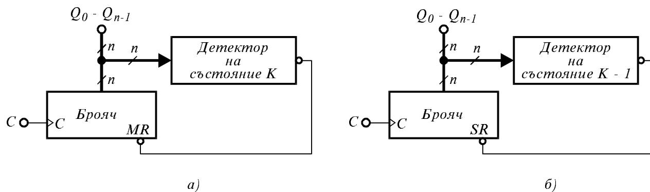
Фиг. 4.44. Съкрашаване на старшите състояния на брояч: а) — при използване на асинхронно нулиране; б) — при използване на синхронно нулиране.
