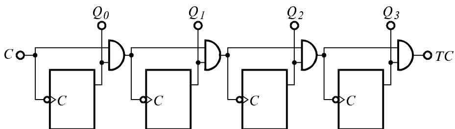
Фиг. 4.21. Четириразреден асинхронен брояч с последователен пренос.
