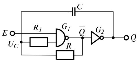
Фиг. 5.20. Прост  $RC$ -релаксатор с CMOS логически елементи.
