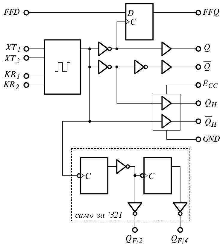
Фиг. 5.33. Структурна схема на интегралните генератори '320 и '321.
