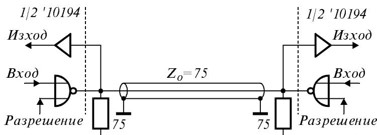
Фиг. 9.13. Реализиране на дуплексна връзка 'point to point' по коаксиален кабел.
