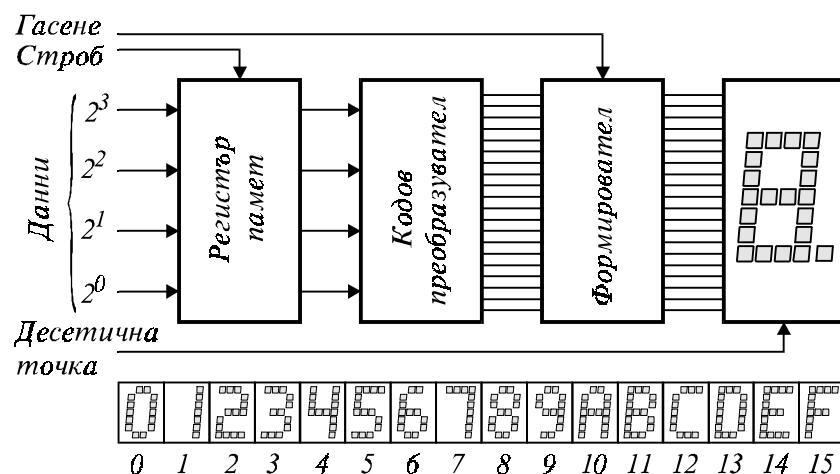
Фиг. 6.14. Блокова схема на единичен дисплей, изобразяващ цифри в шестнадесетична бойрна система — TIL305, TIL511, HP5082, HP7340 и др.
