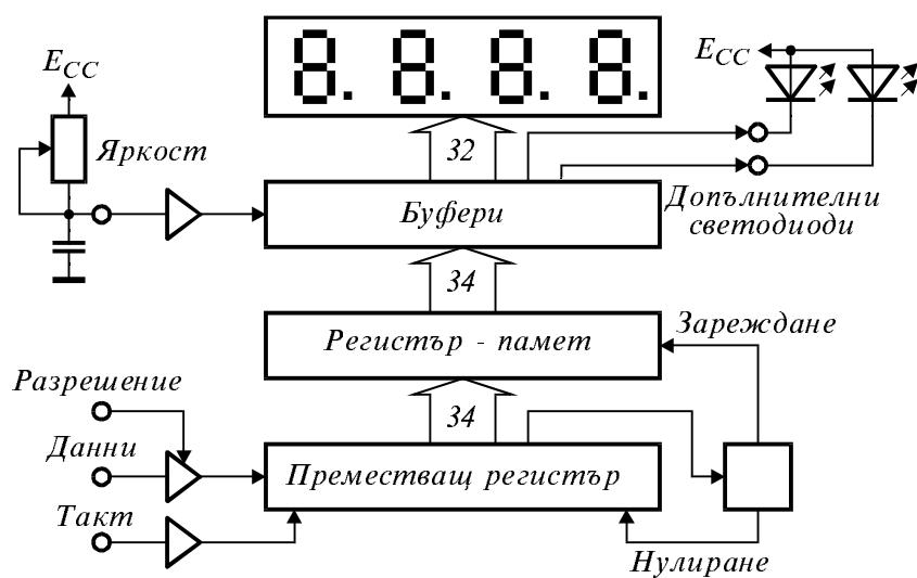
Фиг. 6.15. Четириразредна 7-сегментна индикаторна система NSM4000A.
