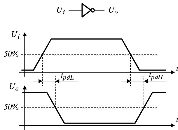
Фиг. 1.13. Закъснение при разпространяването на цифров сигнал.
