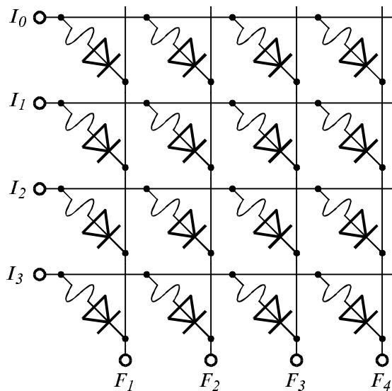
Фиг. 3.36. Програмируема схема на базата на диодна матрица.
