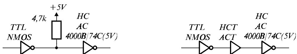
Фиг. 2.46. Свързване от TTL/NMOS към CMOS.
