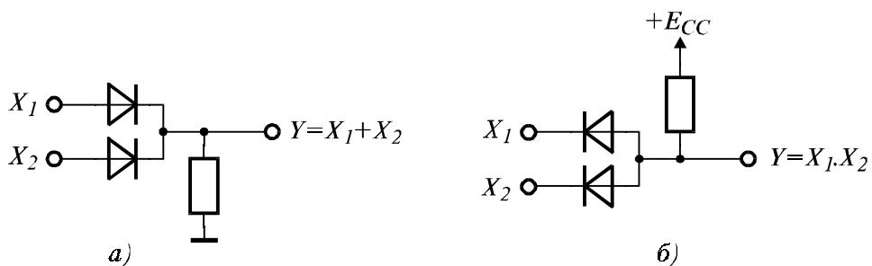
Фиг. 2.4. Диодна логика: а) — ИЛИ; б) — И.
