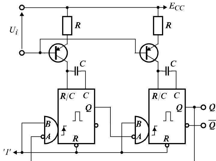
Фиг. 8.9. Управляван с напрежение генератор, изграден на базата на чакащи мултивибратори.
