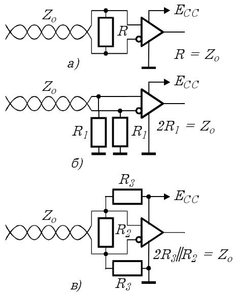
Фиг. 9.10. Терминиране на симетрична линия.
