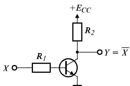
Фиг. 2.1. Електронен ключ с биполярен транзистор.
