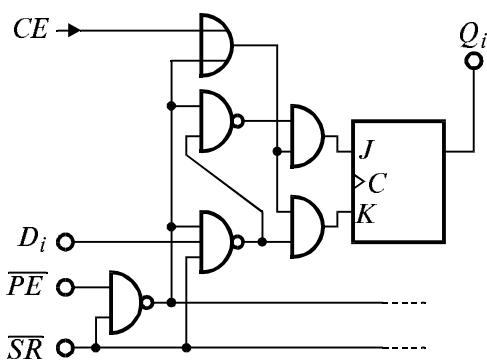
Фиг. 4.32. Съчетание на синхронно зареждане и приоритетно синхронно нулиране на боячен тригер.
