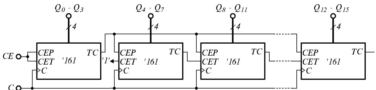
Фиг. 4.39. Синхронно паралелно-последователно свързване на броячи '161
