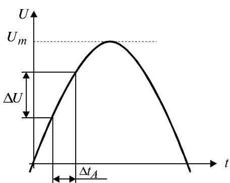
Фиг. 7.17. Възникване на апертурна грешка в АЦП.
