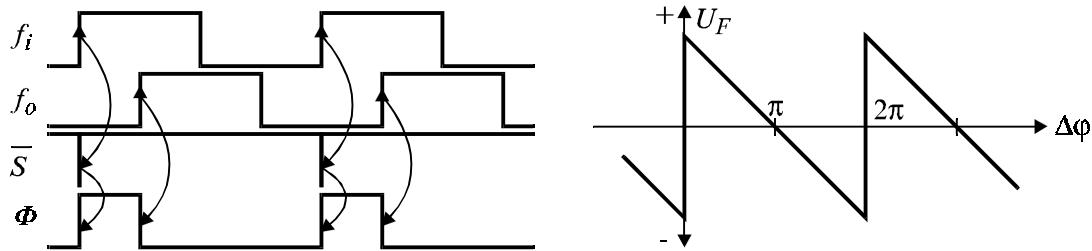
Фиг. 8.4. Цифров линеен фазов детектор от тип 2.
