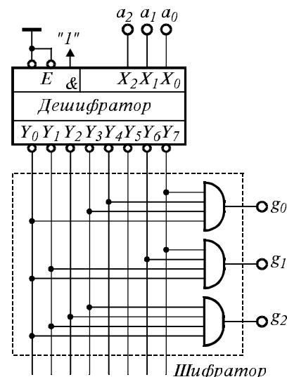
Фиг. 3.20. Кодов преобразувател от двоичен код в код на Грей.
