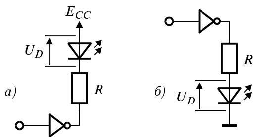
Фиг. 6.2. Възбуждане на светодиод от логически елемент.
