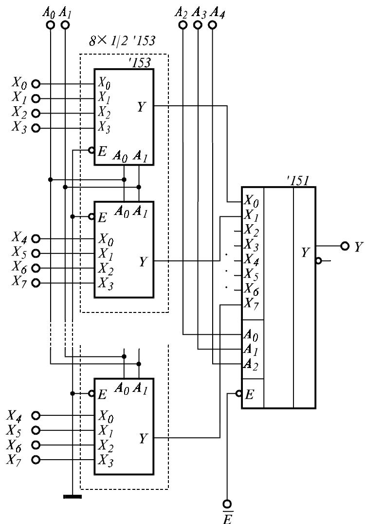
Фиг. 3.14. Каскадно нарастване на мултиплексор. 32-канален мултиплексор.
