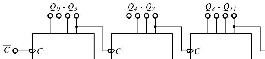
Фиг. 4.33. Асинхронно свързване на броячи.
