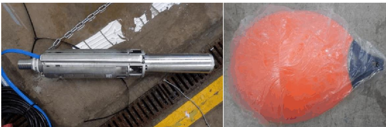
фигура 5 - Потопяема помпа и нейната шамандура
