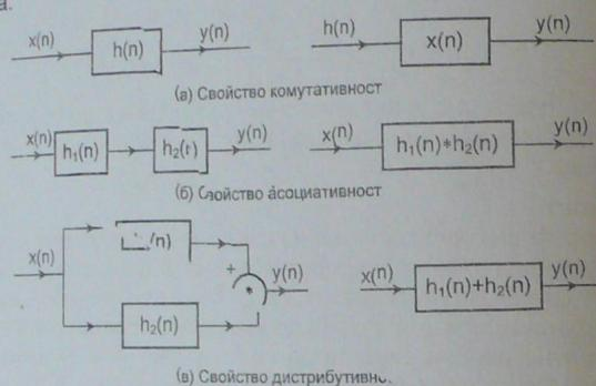
Фиг. 1.5. Интерпретация на свойства на конволюцията от гледна точка на системата
