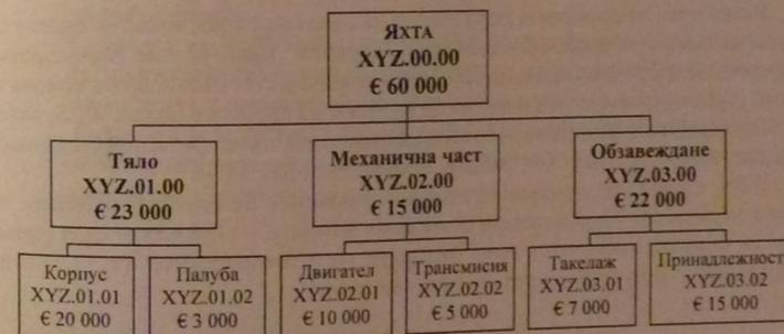
Фиг. 14.6. Агрегатиране на разходите на проекта за сглобяване на яхта
