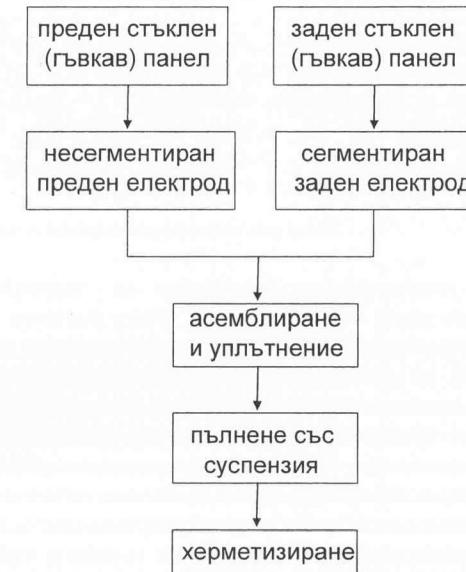
Фиг. 7.6 Технологичен ред за изготвяне на електрофорезен дисплей.
