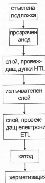
Фиг. 4.7 Технологичен ред за изготвяне на OLED
