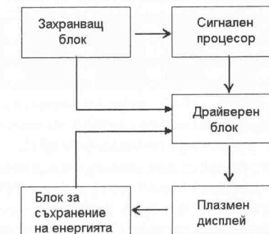
Фиг. 2.9 Блокова схема на системата за управление на AC PDP.
