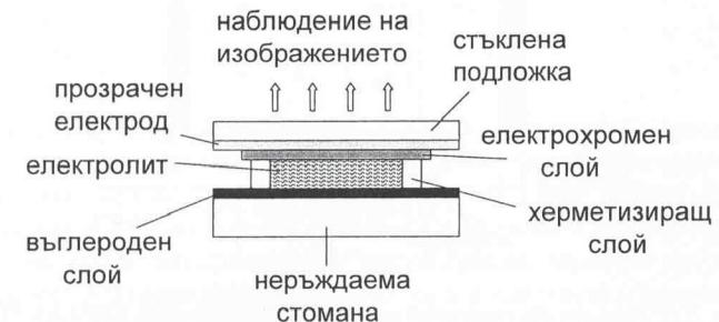
Фиг. 6.1 Примерна структура на електрохромна дисплейна клетка.
