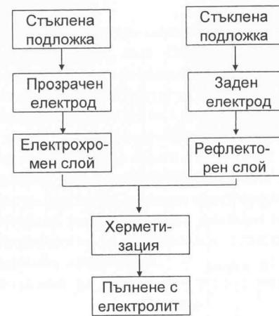
Фиг. 6.4 Технологичен ред за изготвяне на електрохромен дисплей.
