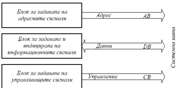
Фиг. 3.2. Блокова схема на тестер за статични въздействия.
